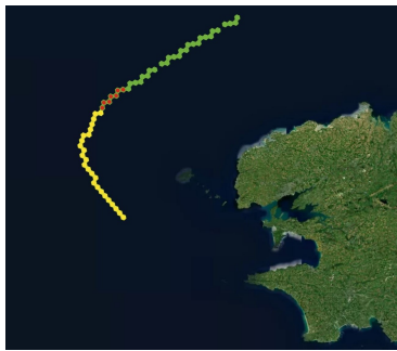
FIG. 5 – Exemple de suivi de route courbe par le modèle prédictif. Jaune : hexagones donnés au modèle, rouge : trajectoire réelle, vert : prévision
