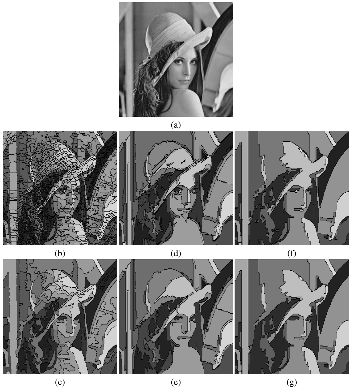
FIG. 2.21 – (a) Image "Lena" (b) Segmentation par LPE : 1855 régions (c) Post-filtrage par l'algorithme 4 : 94 régions. (d) Segmentation par EGBIS : 205 régions (e) Post-filtrage par l'algorithme 4 : 50 régions. (f) Segmentation par SRM : 62 régions (g) Post-filtrage par l'algorithme 4 : 48 régions.
