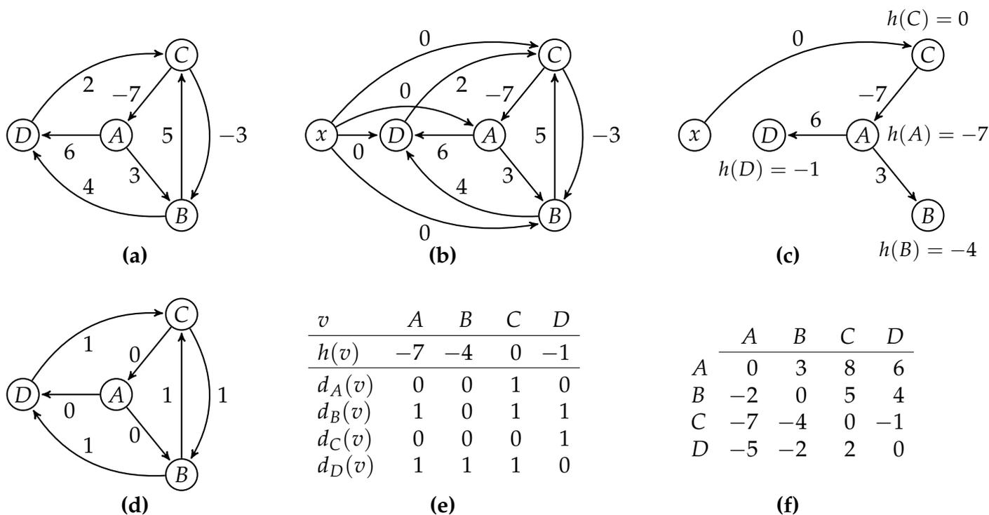
L'algorithme de Johnson calcule les distances  $D(u, v)$  pour toutes les paires de sommets  $(u, v) \in V^2$  d'un graphe orienté  $G = (V, E, \ell)$  ne possédant pas de cycle négatif. Il fonctionne en plusieurs étapes, illustrées par les figures ci-dessus. La figure (a) représente le graphe fourni en entrée, et le tableau (f) est la sortie qui donne les distances pour toutes les paires.
