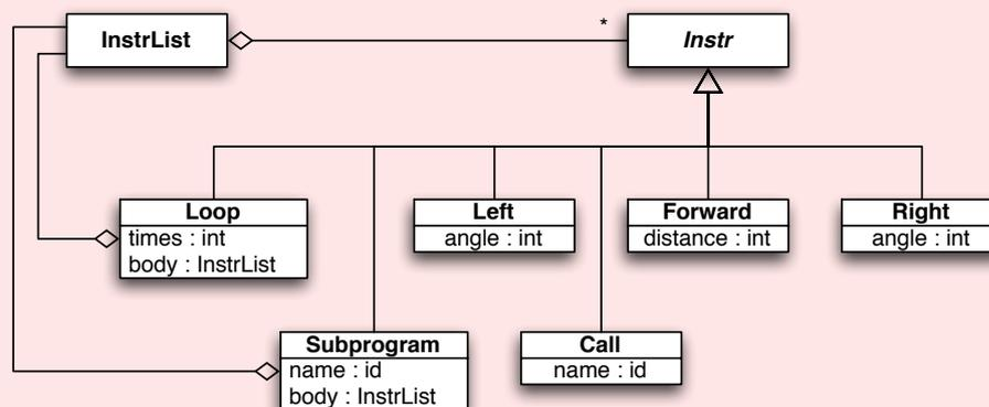
Notez que l'on peut factoriser les nœuds Forward, Left et Right en une unique classe Move, comportant une étiquette (implémentée avec une enum par exemple) permettant d'identifier la nature du mouvement.
